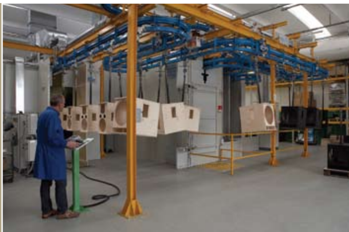
Автоматическая линия покраски — особая гордость FBT. На предприятиях такого направления это оборудование практически не встречается: дорого.
